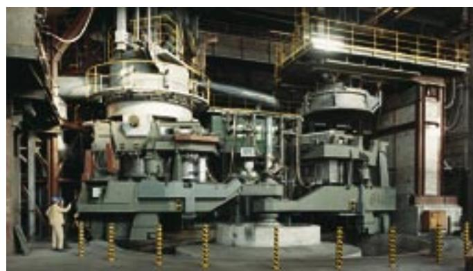
*Les étapes essentielles du procédé, la désoxydation, le dégazage et la dé sulfuration sont ensuite réalisés dans l'installation de traitement en poche après la coulée.*
